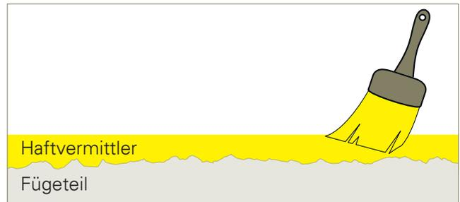
Wenn das Lösungsmittel verdunstet ist, kann der Kleb- / Dichtstoff die Oberfläche vollständig benetzen. Lufteinschlüsse werden so verhindert und die Kontaktfläche vergrößert.
