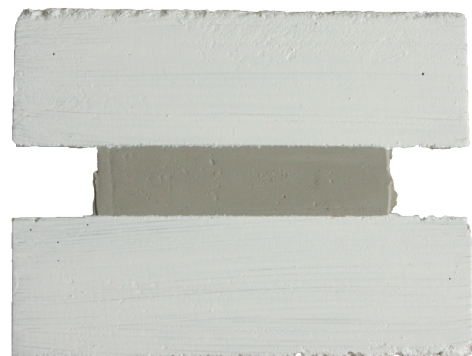
Beispiel eines Prüfkörpers bei der Prüfung der Anstrichverträglichkeit
