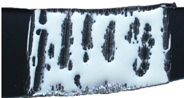
Beispiel einer Verlaufsstörung beim Beschichten eines silikonbasierten Produktes
