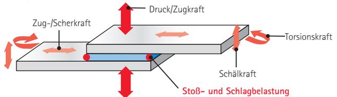
Reiß-Kraft Indoor Panel Klebstoff zeigt sich sehr stabil bei mechanischen und thermischen Belastungen und verhindert gleichzeitig Schallbrücken und Korrosion.
