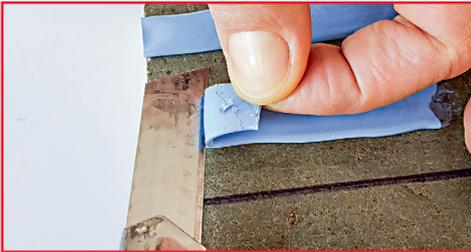
Sind Schritt 1 und 2 erfolgreich durchgeführt, wird auf den zu verklebenden Untergründen ein Raupenschältest durchgeführt. Hierzu wird der IPK mit einer 5 cm langen Raupe auf die zu verklebenden Materialuntergründe aufgetragen. Mit einem Spachtel wird die Raupe auf ca. 2 mm Stärke glatt gespachtelt.
