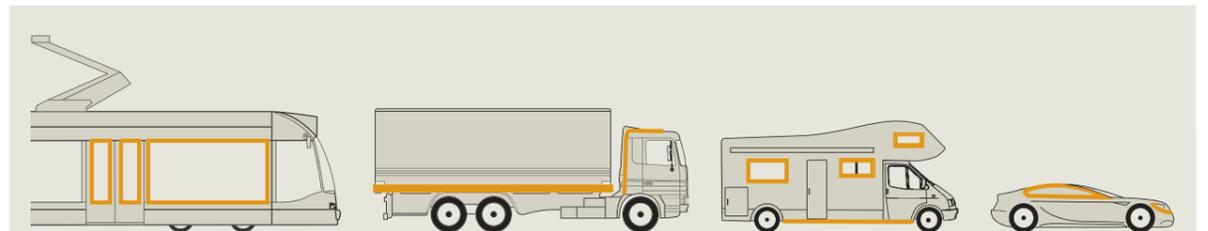
Ob für Autos, Schienen- oder Spezialfahrzeuge: Das Automotive-Sortiment von **merz+benteli** beinhaltet Produkte für die verschiedensten Bereiche im Fahrzeugbau, so etwa für Verklebungen von Scheiben und Teilen im Innenbereich, für Nahtabdichtungen und für grossflächige Verklebungen.
