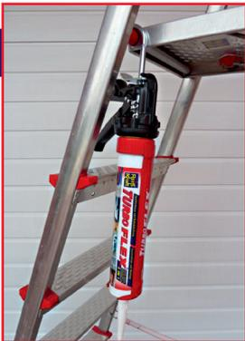
Manuelle Auspresspistole für Kleb- und Dichtstoffe in 150, 290 und 310 ml Standardkartuschen. Entlastungsriegel mit Nachlaufstopp. Großer Griff mit guter Kraftübertragung. Extra stabile Ausführung aus Metall mit speziell gehärteter Schubstange. Gewicht: 0,93 kg, Kolbenhub: 5 mm, Vorschubkraft: 400 kg, Übersetzung: 26 zu 1.
