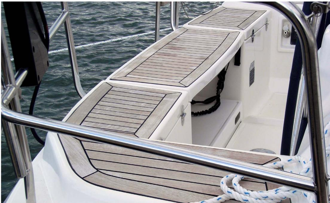
Mit Merbenit DB50 geklebte vorgefertigte Stabdeckplatten
