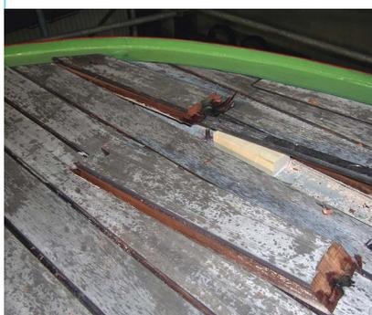
Vorbereiten der Fugenflanken: Bei Renovationen sollen die Fugenflanken vorgängig gefräst und/oder geschliffen werden. Defekte Planken werden durch neue ersetzt. Für die Verklebung von Teakplanken ist Merbenit DB 50 zu verwenden.
